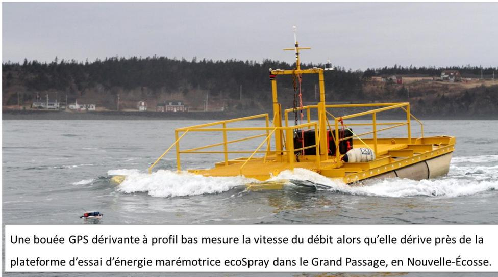
Une bouée GPS dérivante à profil bas mesure la vitesse du débit alors qu'elle dérive près de la plateforme d'essai d'énergie marémotrice ecoSpray dans le Grand Passage, en Nouvelle-Écosse.
